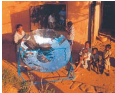
↓ Solarna kuhala, koja se u zemljama u razvoju sve više koriste, zagrijavaju hranu koncentriranjem sunčevih zraka. To je ekonomičan sustav koji istodobno služi i kao pećnica i kao štednjak. www.solarcooking.org
